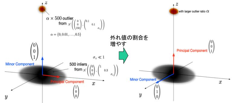
・z軸方向の分散を適切に変化させることで、Lower Bound of Breakdown Point (LBBP)の値を変える。
