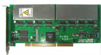
Fig.-6 第2世代物理乱数発生ボード 2004年 東芝 発生速度 133MB/秒 Altix2800を中心とした統計科学スーパーコンピュータシステムに6枚のボードを装着して利用
