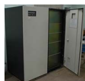
Fig.4-b 第3代物理乱数発生機 1989年 発生速度 1.5MB/秒 M682Hを中心とした統計科学コンピュータシステムで利用(HITAC S3800/162を中心としたシステムまで利用)
