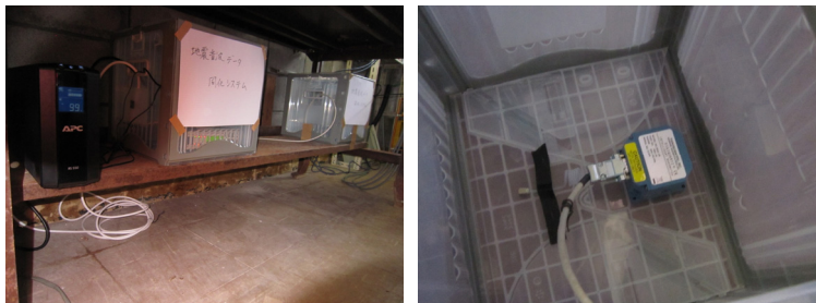
図2: (左)長野県菅平および和歌山県潮岬に展開されている地震音波データ同化システム(右)高感度微気圧センサー Nano-Baro Model 6000-16B
