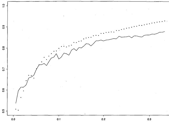
図1. 横軸がデータ点(既知の画素)の比率, 縦軸が推定されたパターンと真のパターンとの重なり. 上の点線が適応的サンプリング, 下の折れ線がランダムサンプリングに対応.
