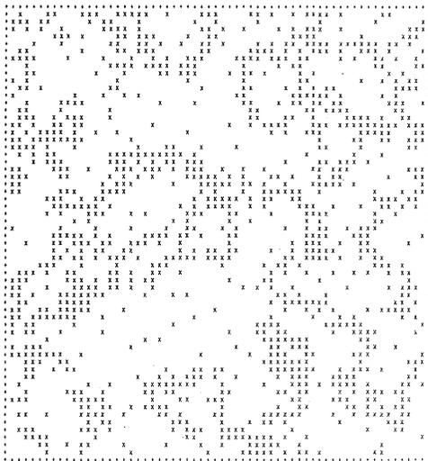
図2. 適応的サンプリングによって選ばれたデータ点(既知の画素)の分布の例. データ点を×印, 未知の画素を空白で示す.
