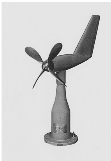
図 1. プロペラ型風向風速計 .
